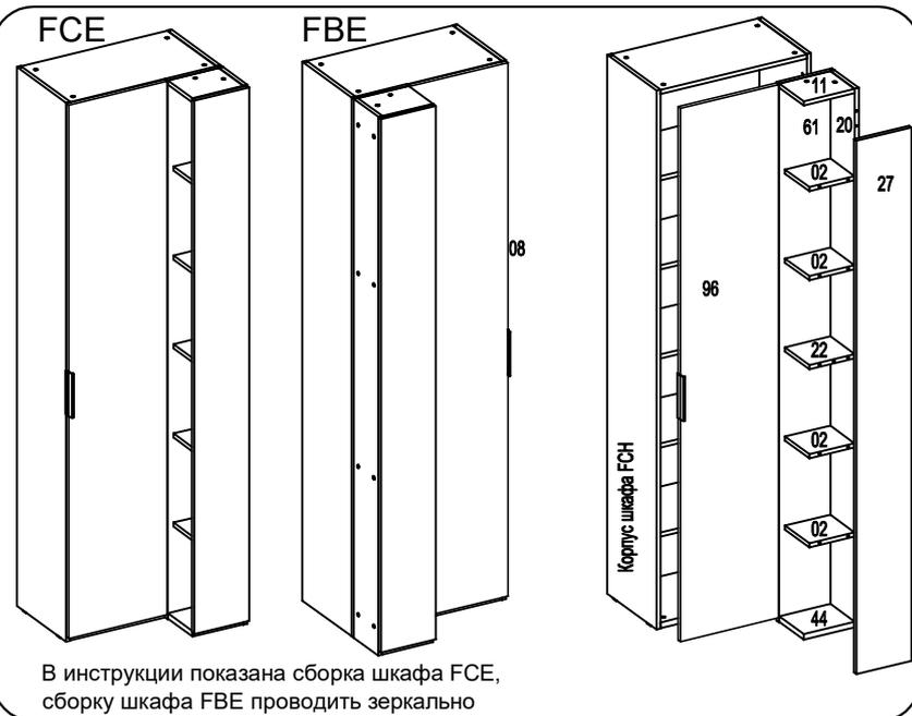
В инструкции показана сборка шкафа FCE, сборку шкафа FBE проводить зеркально
